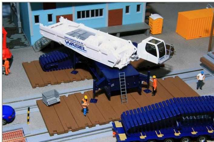
Baggermatten im Einsatz bei einem Raupenkran zum Schutz des Asphaltbelages.
